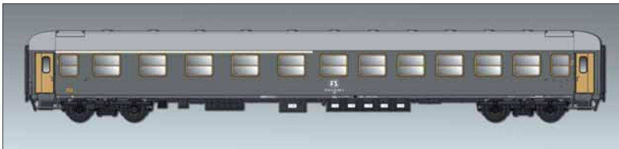
Carrozza FS mista di 1ª e 2ª classe Tipo UIC-X 1964, con porte in alluminio anodizzato, livrea grigio ardesia. FS 1 st /2 nd class car Type UIC-X 1964 with aluminium doors, slate gray livery. 1./2.-Klasse-Wagen Typ UIC-X 1964 der FS mit eloxierten Aluminiumtüren, schiefergraue Lackierung.
